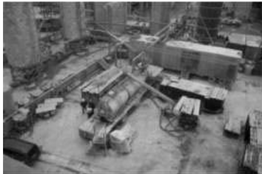
Abbildung 1. Sotem-Anlage zum Mischen von organischen Abfällen [1]
